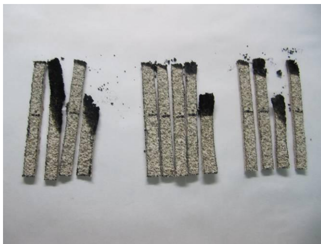
Afbeelding 5. Representatieve staal van het materiaal DECOPROYEC-3: (a) tijdens de test; (b) na de test
